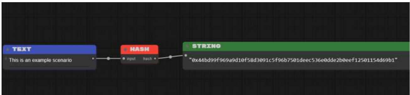
Εικόνα 11.3 Τα blocks που χρειάζονται για τη δοκιμή χρήσης μιας συνάρτησης κατακερματισμού (είσοδος + έξοδος).
